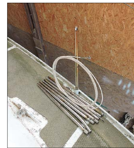
▲ Le démontage des chandeliers et des filières n'a pas posé de problème particulier.
