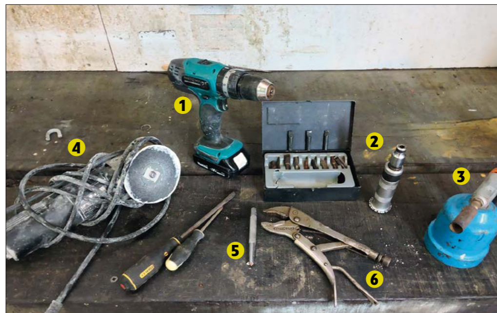
▲ La dévisseuse (1) n'est utile que dans les cas les plus faciles, hélas rarissimes. Mais elle est très utile en mode perceuse en complément du poinçon (5). Le tournevis à frapper et ses embouts (2) sont tout simplement indispensables. Le chalumeau (3) est très utile pour extraire la visserie inox d'un pont alu et la disqueuse (4) ultra efficace dans les cas désespérés. Quant à la pince-étoupe, elle peut faire office d'extracteur, par exemple (dans notre cas) pour une vis attaquée à la disqueuse.
