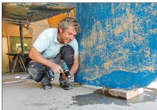
▲ Quelle mauvaise surprise que toute cette eau de mer qui s'écoule de notre quille!
