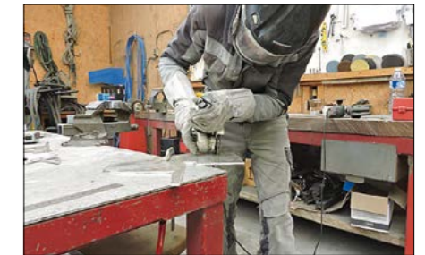
▲ Découpe minutieuse et au cas par cas des plaques d'aluminium.
