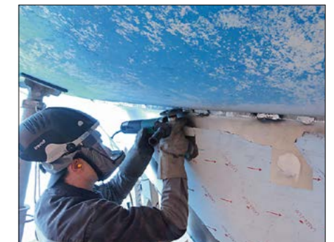
▲ Affinage des soudures pour permettre une meilleure pénétration dans l'eau.
