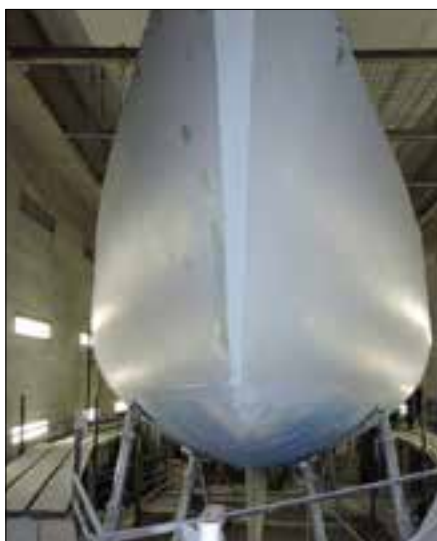
▲ A gauche, la coque préparée, poncée, enduite là où des reprises étaient nécessaires, re-poncée et couverte d'un apprêt. A droite, la même coque après peinture et ajout des lignes décoratives.
