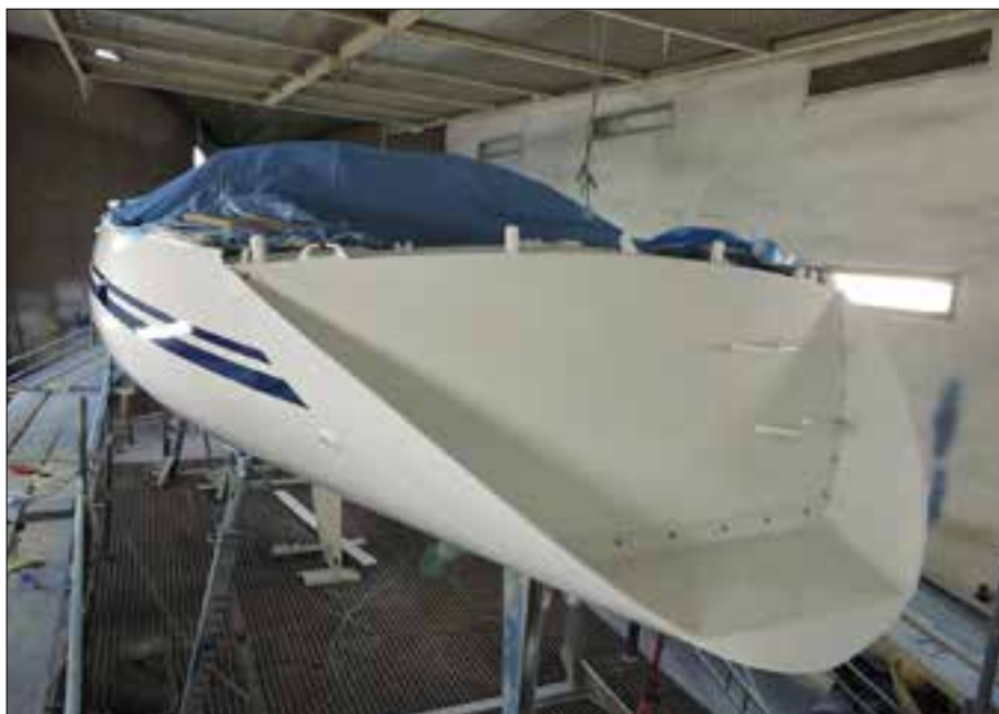
▲ L'ajout d'une jupe vient compléter les travaux de rénovation effectués sur la carène et le pont. Au final, le nouveau Diaphani n'aura plus grand chose à voir avec l'ancien...
