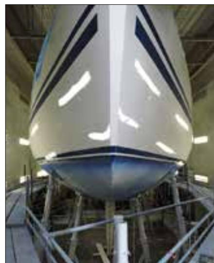
▲ A gauche, la coque préparée, poncée, enduite là où des reprises étaient nécessaires, re-poncée et couverte d'un apprêt. A droite, la même coque après peinture et ajout des lignes décoratives.
