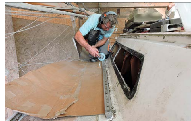
▲ La première étape du refit, à savoir le désaccastillage complet du bateau, a duré près de deux mois et usé de nombreux outils! (VM n°243).
