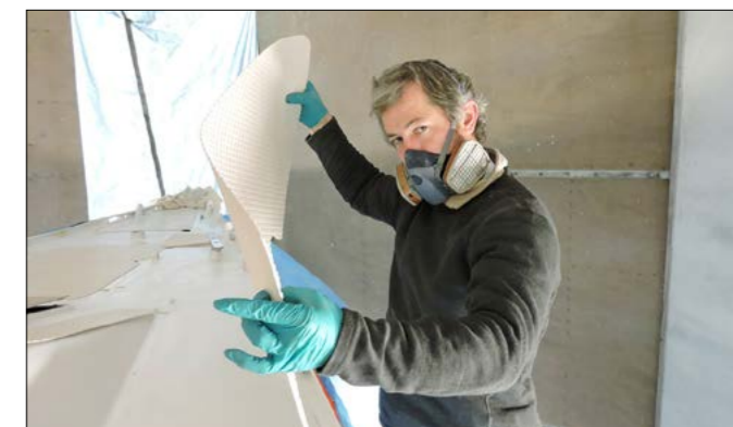
▲ Tous les panneaux ont été numérotés en amont à partir d'un plan pour être sûr de les positionner à la bonne place.
