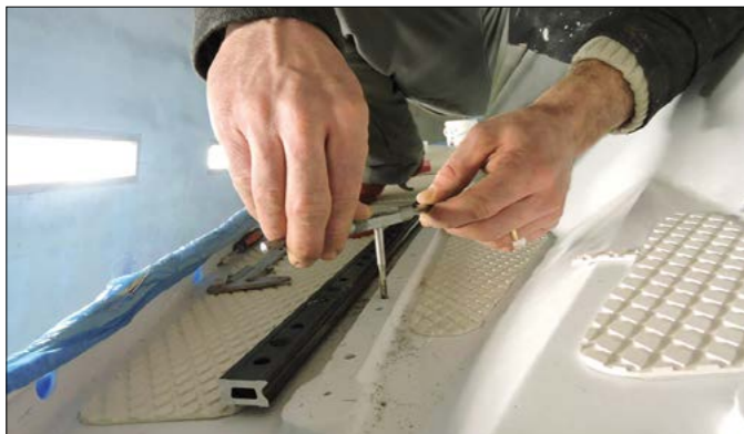
▲ Le taraudage est une technique exigeante qui nécessite de bien calculer la taille et la profondeur de chaque trou à venir.
