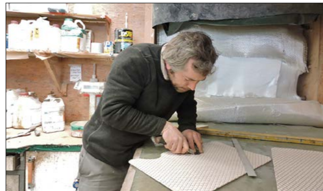
▲ Une découpe précise et soignée des différents panneaux de Trade Master est indispensable avant de se lancer dans le collage.
