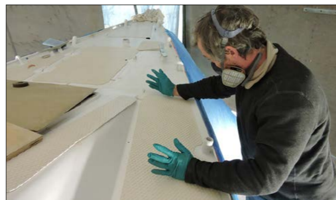
▲ On peut utiliser les mains ou un rouleau pour maroufler au mieux et limiter la création de bulles d'air afin de garantir une adhérence parfaite.
