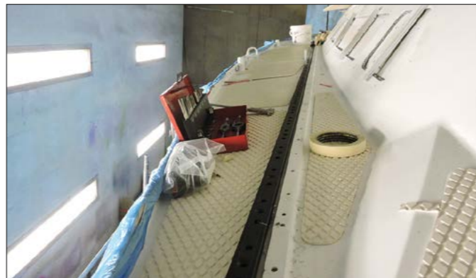
▲ Les trous du nouveau rail de chez Ronstan ne correspondent pas exactement à ceux d'origine. Taraudage obligatoire!
