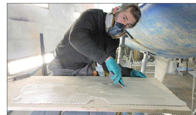
▲ Gants et masque sont indispensables au moment de travailler la colle époxy hautement toxique et à forte abrasivité.
